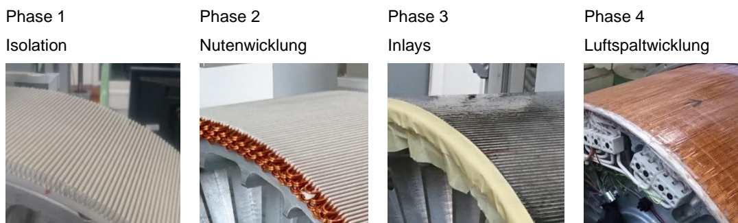
Abbildung 53: Produktionsphasen der Statorwicklung
