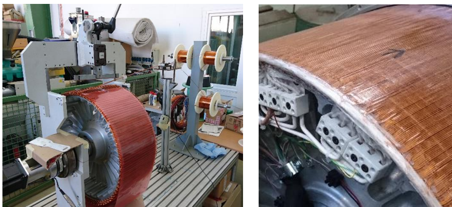
Abbildung 57: Aufkleben der Luftspaltwicklung und vollständige Kombinationswicklung
