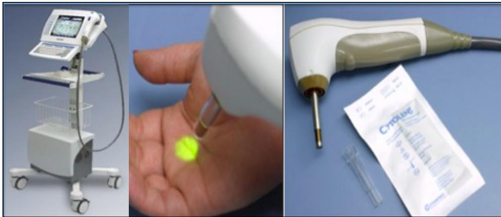
**Abbildung 5:** „Cytoscan®“ Gefäßmikroskop. Der Messkopf gibt monochromatisches und polarisiertes Licht ab (Wellenlänge  $\lambda=548$  nm). Rechts die zur Aufnahme nötige Kunststoffkappe, welche in ihrer Spitze eine integrierte Linse hat und somit Bestandteil des optischen Gesamtsystems ist.
