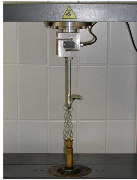
Abb. 07 Prüfkörper, eingespannt in Zugvorrichtung
