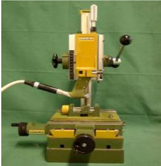
Abb. 21: Durch die Kopfräsvorrichtung wird eine Standardpräparation in 3 Dimensionen möglich, und die Kavitäntiefe ist durch den Tiefenanschlag gesichert.
