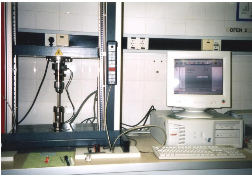
Abb. 30: Arbeitsplatz mit Universalprüfmaschine Zwick Z 005 mit eingespanntem Bencor Multi- T Aufsatz, rechts der zum Steuern der Mikrohaftkraft- Versuche verwendete Computer mit Zwick TestXpert V8.1.
