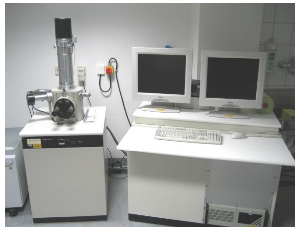
Abb. 34: Arbeitsplatz mit REM Hitachi S520 und dazugehöriger Hardware incl. der Betrachtungsmonitore
