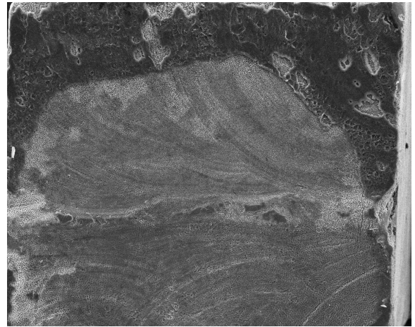
Abb.64: Mittlere Übersicht bei gemischtem Bruch, im oberen Anteil deutliche Flow- Kompositreste (100x)
