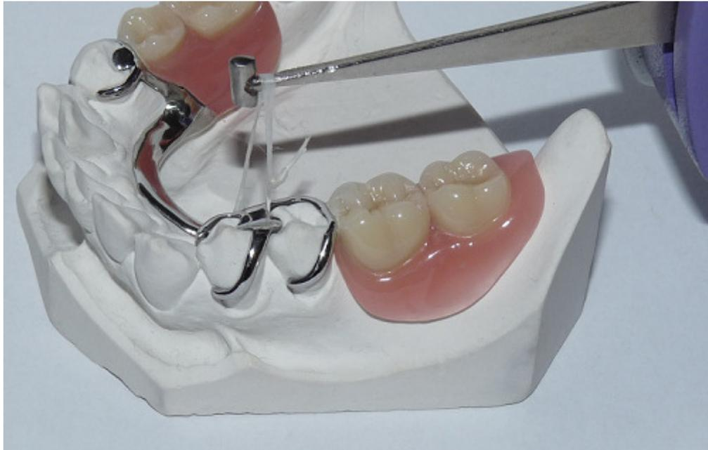
Abb. 8: Retentionskraftmessung an einer Doppelklammer, veranschaulicht auf einem Modell
