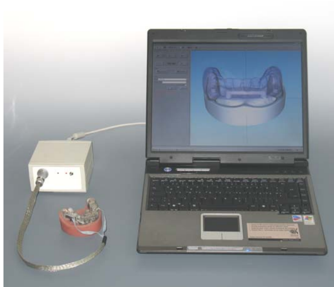
Abbildung 2 Entwickeltes Messsystem bestehend aus Prothese mit Sensor-Modulen, A/D-Wandler & Verstärker und Computer mit Auswertungssoftware
