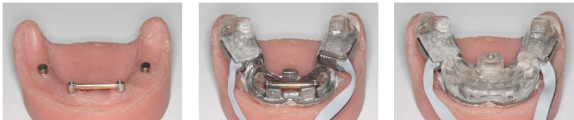
Abbildung 21 In-vitro Testmodell (links mit Steggerüst), Prothese ohne (Mitte) und mit verschraubtem Aufnehmer (rechts)
