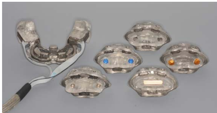
Abbildung 20 skelettiertes Prothesengerüst mit eingeklebten Sensor-Modulen und einzelnen Aufnehmern mit einpolymerisierten Sekundärteilen / Matrizen (Ansicht von basal v.l.n.r.: Kugelknopf, Locator, Magnet, Steg, Teleskop)
