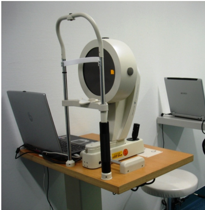
Abbildung 3-4 Pentacam-Kamera, Fa. Oculus
