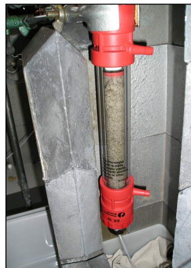
Abb. 14: Experimentelle Säule mit Granit (0,2-0,3 mm)
