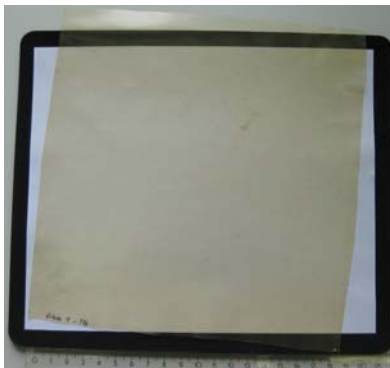
Abbildung 3-34: Filmherstellung aus Erbsenprotein in Abhängigkeit der Gewinnung, ohne MTG. 6 g Proteinpulver, 3 g Glycerin und 1,5 g Maltodextrin in 110,4 mL 20 mM Tris/HCl-Puffer pH 7 für 30 min bei 90 °C gelöst, pH-Einstellung auf pH 7 (bei RT), 30 min bei 50 °C inkubiert, 6 mL vorgewärmten Puffer hinzugefügt, anschließend Luftblasen entfernt und in 200 x 200 mm PTFE-Form gegossen, bei RT für 48 h getrocknet, 48 h bei 23±2 °C und 50±3 % rLF in einem Exsikkator konditioniert.
