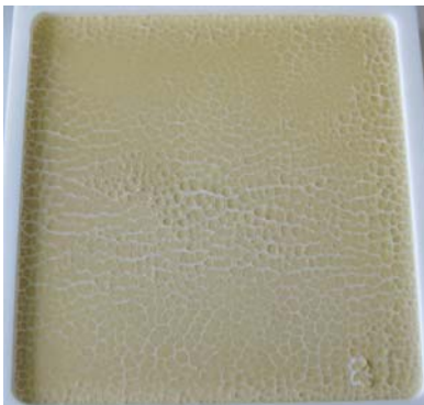
Abbildung 3-34: Filmherstellung aus Erbsenprotein in Abhängigkeit der Gewinnung, ohne MTG. 6 g Proteinpulver, 3 g Glycerin und 1,5 g Maltodextrin in 110,4 mL 20 mM Tris/HCl-Puffer pH 7 für 30 min bei 90 °C gelöst, pH-Einstellung auf pH 7 (bei RT), 30 min bei 50 °C inkubiert, 6 mL vorgewärmten Puffer hinzugefügt, anschließend Luftblasen entfernt und in 200 x 200 mm PTFE-Form gegossen, bei RT für 48 h getrocknet, 48 h bei 23±2 °C und 50±3 % rLF in einem Exsikkator konditioniert.
