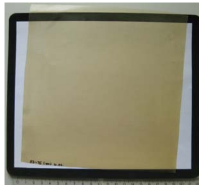
Abbildung 3-34: Filmherstellung aus Erbsenprotein in Abhängigkeit der Gewinnung, ohne MTG. 6 g Proteinpulver, 3 g Glycerin und 1,5 g Maltodextrin in 110,4 mL 20 mM Tris/HCl-Puffer pH 7 für 30 min bei 90 °C gelöst, pH-Einstellung auf pH 7 (bei RT), 30 min bei 50 °C inkubiert, 6 mL vorgewärmten Puffer hinzugefügt, anschließend Luftblasen entfernt und in 200 x 200 mm PTFE-Form gegossen, bei RT für 48 h getrocknet, 48 h bei 23±2 °C und 50±3 % rLF in einem Exsikkator konditioniert.
