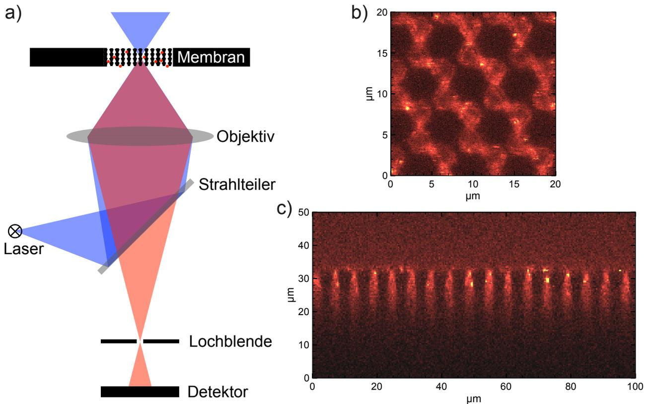
Abbildung 7.1: a) Schema der Konfokalmikroskopie, b) Aufnahme einer porösen SiO<sub>2</sub>-Membran bei einer Anregungswellenlänge von 470 nm. Die Abbildung wurde senkrecht zur Porenwachstumsrichtung in Nähe der Membranoberfläche aufgenommen. c) Aufnahme senkrecht zur Oberfläche. Das Objektiv befindet sich oberhalb der Membran und Licht kann nur etwa 15 µm weit in die Membran eindringen.
