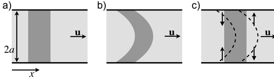
Abbildung 3.4: Taylor-Dispersion in einem zylindrischen Kanal mit Radius  $a$ . a) Zu Beginn befindet sich ein gelöster Stoff mit konstanter Konzentration in einem Abschnitt des Kanals (dunkelgrau). b) Unter Vernachlässigung der Diffusion formt sich die Lösung durch den Poiseuille-Fluss  $\mathbf{u}$  im Kanal zu einem parabelförmigen Konzentrationsprofil. c) Mit Diffusion gleicht sich die Deformation aus (nach [Bru08]).
