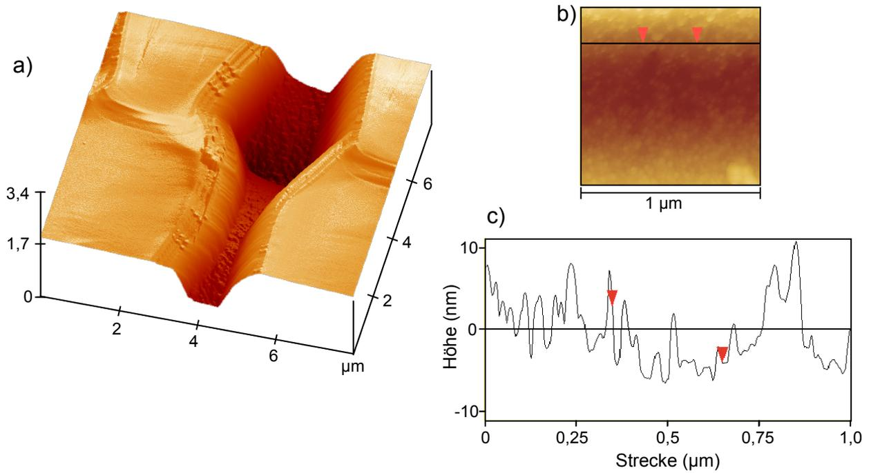
Abbildung 4.4: Rasterkraftmikroskopische Aufnahmen von Poren in gespaltenen Membranen: a) Aufnahme einer modulierten Pore, b) Aufnahme eines  $1\mu\text{m}^2$  großen Bereichs einer geraden Pore, c) Höhenprofil im selben Bereich entlang der Porenwachstumsrichtung.
