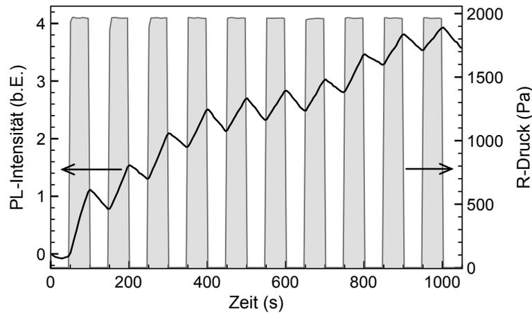
Abbildung 5.3: Per CCD-Kamera aufgenommenen Photolumineszenz von 100 nm Teilchen und der Mittelwert des Drucks in Abhängigkeit von der Zeit. Die Druckmodulationen werden alle 50 s an- und ausgeschaltet.
