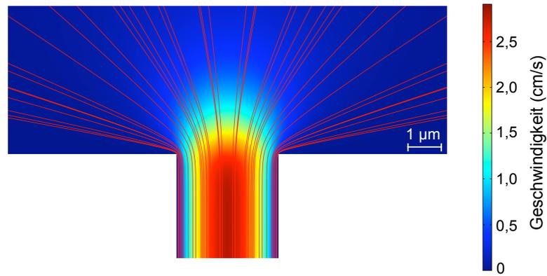
Abbildung 5.26: Simulation von Geschwindigkeitsfeld und Strömungslinien an einer Porenöffnung. An dem 100  $\mu\text{m}$  langen Kanal mit einem Durchmesser von 3  $\mu\text{m}$  liegt ein Druck von 5000 Pa an. Das Feld wurde durch eine Finite-Elemente-Berechnung der Navier-Stokes-Gleichungen in Zylindersymmetrie bestimmt.
