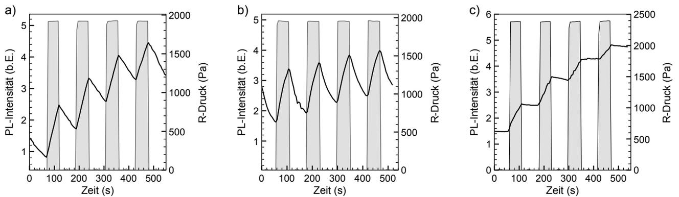
Abbildung 5.5: Unterschiedliche Photolumineszenz-Verläufe. a) Gerader Verlauf Zu- und Abnahme der PL-Intensität, b) Gekrümmter PL-Verlauf, c) Geringer PL-Abfall in den Aus-Phasen.
