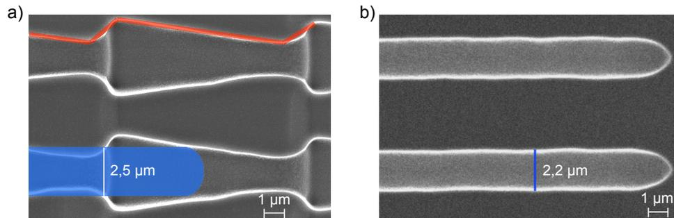
Abbildung 5.7: REM-Aufnahmen gespaltener Membranen. Die Porenformen entsprechen denen der Membranen, die für die in Abb. 5.6 gezeigten Messungen verwendet wurden. a) Asymmetrische Poren. Die roten Strecken zeigen die Näherung der Porenform, mit welcher der hydraulische Äquivalentdurchmesser (blau) bestimmt wurde. b) Gerade Poren, aufgenommen vor der KOH-Rückseitenöffnung.
