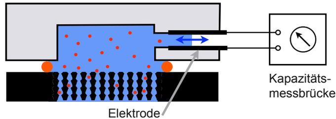
Abbildung 5.15: Schema der kapazitiven Bestimmung der Volumenänderung im oberen Reservoir.
