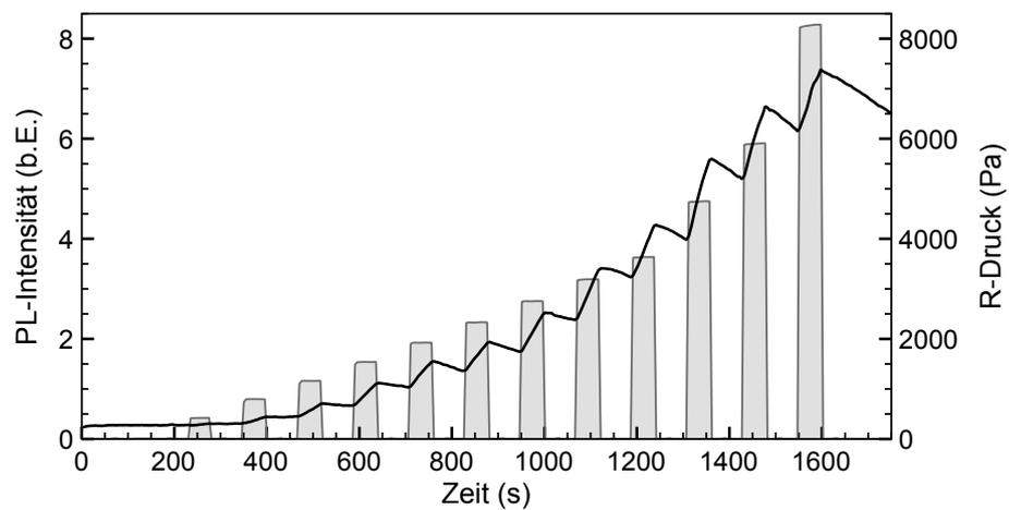
Abbildung 5.8: Photolumineszenz 100 nm großer Teilchen bei verschiedenen Drücken. Gemessen wurde mit einer negativ orientierten asymmetrischen Membran.
