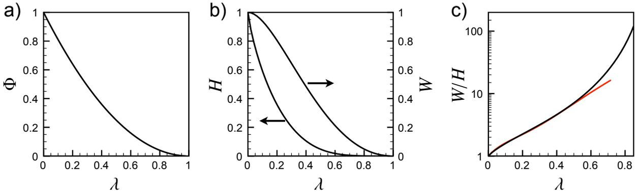
Abbildung 3.8: Partitionierungs-Koeffizient  $\Phi$  und die hindrance-Faktoren  $W$  und  $H$  und ihr Verhältnis  $W/H$  in Abhängigkeit von der relativen Teilchengröße  $\lambda$ . Die rote Linie in c) ist die Näherung an  $W/H$  durch die kubische Gleichung aus Gl. (3.44) und Gl. (3.46).
