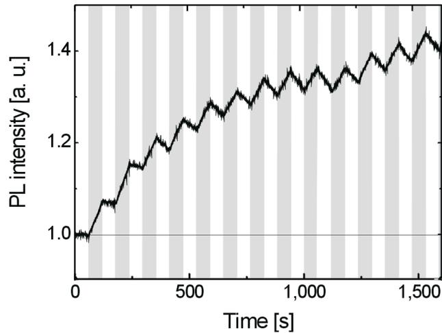
Abbildung 5.1: Photolumineszenz-Intensität als Funktion der Zeit. Gemessen ist die PL von  $0,32 \mu\text{m}$  großen Teilchen im oberen Bassin. Die Druckoszillationen von  $2000 \text{ Pa}$  und  $40 \text{ Hz}$  wurden alle  $60 \text{ s}$  an- und ausgeschaltet; die An-Phasen sind grau unterlegt (Abbildung: S. Matthias).
