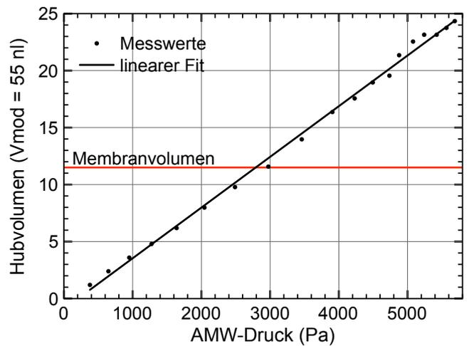
Abbildung 5.20: Hubvolumen als Funktion des AMW-Drucks im unteren Bassin für zwei verschiedene Druckbereiche.
