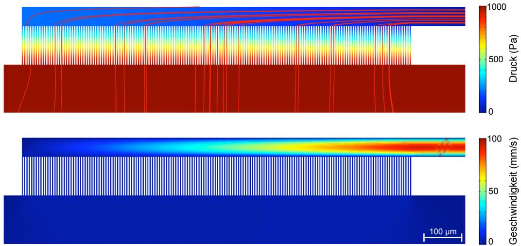
Abbildung 7.2: 2D-Finite-Elemente Simulation des Flusses und Druckverlaufs in einem Ausschnitt von Membran und Reservoiren. Im unteren Bassin liegt ein konstanter Druck von 1000 Pa an. Das Wasser kann aus dem 50 µm hohen oberen Bassin nur seitlich entweichen. Im oberen Bild sind Strömungslinien markiert.
