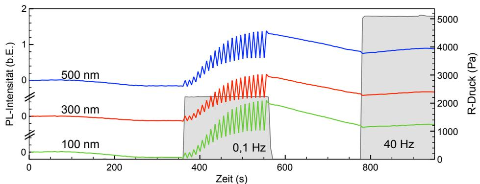
Abbildung 5.12: Messung an einer asymmetrischen Membran mit 2  $\mu\text{m}$  Porenabstand und 420 nm Äquivalentradius. Die Druckmodulation beträgt 0,1 Hz und 40 Hz. Bei der niedrigen Frequenz werden einzelne Druckoszillationen zeitlich aufgelöst.
