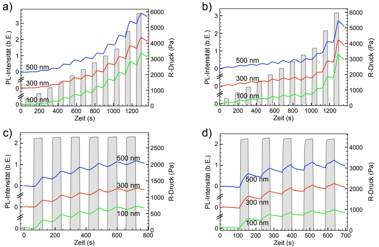
Abbildung 5.11: Gleichzeitig gemessene PL-Entwicklung für 100 nm, 300 nm und 500 nm große Teilchen für verschiedene Membrantypen: a) Druckabhängige Messung für eine symmetrische Membran in negativer Orientierung, b) Messung an derselben Membran mit positiver Orientierung, c) Membran mit zylindrischen Poren, d) Membran mit asymmetrischen Poren mit einem hydraulischen Äquivalentradius von 420 nm.
