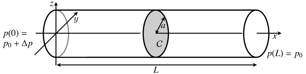
Abbildung 3.1: Poiseuille-Fluss durch einen Kanal mit runder Querschnittsfläche mit Radius  $a$ . Der Fluss wird verursacht durch die Druckdifferenz  $\Delta p$  über den Kanal. In der Querschnittsebene bildet sich ein parabolisches Strömungsprofil aus.
