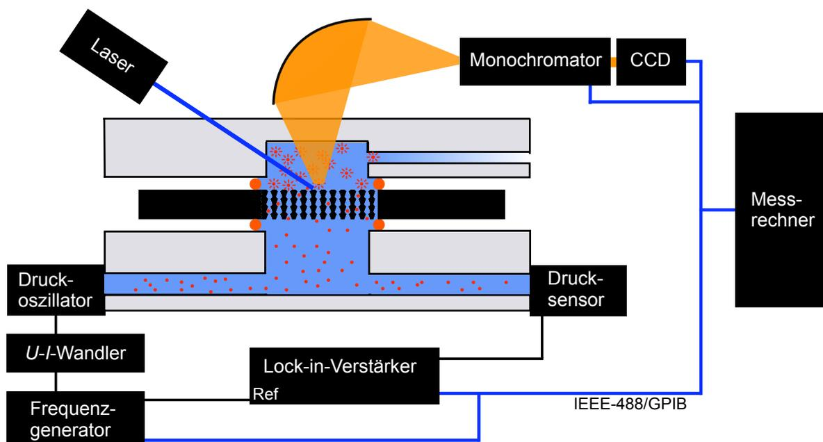
Abbildung 4.6: Experimenteller Aufbau zur Messung des Teilchentransports.
