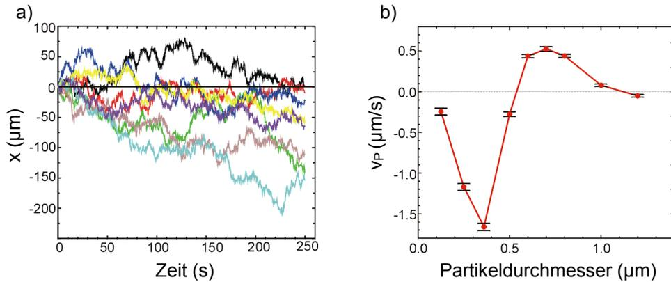
Abbildung 1.2: Numerische Simulation der stochastischen Dynamik von Teilchen in einer Driftratsche. a) Komponente der Bewegung mehrerer Partikel entlang der Porenachse  $x$  in Abhängigkeit von der Zeit. b) Durchschnittliche Partikelgeschwindigkeit  $v_P$  in  $x$ -Richtung in Abhängigkeit von der Teilchengröße (Abbildungen: Universität Augsburg).
