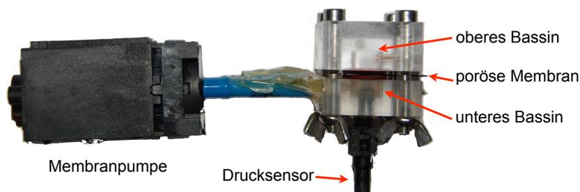
Abbildung 4.5: Messzelle zur Bestimmung des Driftratscheneffekts.
