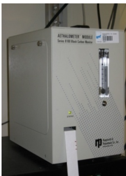
ABBILDUNG 13: SCHEMATISCHER AUFBAU UND FOTO DES AETHALOMETERS.
