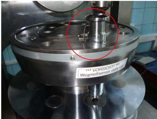
Abb. 3 Biegefeder am Oberstempel zur Wegmessung an der Pressima
