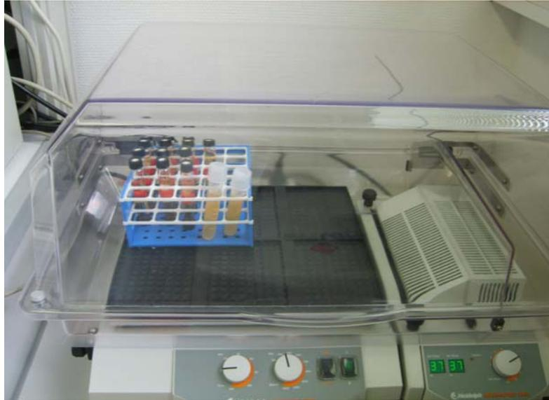
Abbildung 28: Inkubation der Testkörper im Heidolph-Inkubator 1000 bei 400 U/min (Heidolph Instruments GmbH & Co. KG, Schwabach, Deutschland)
