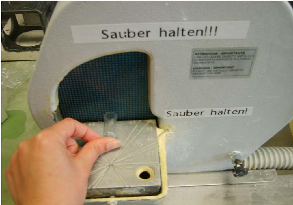
Abbildung 20: Entfernung der Glasböden am Gipstrimmer (Wassermann Dental-Maschinen GmbH, Hamburg, Deutschland)
