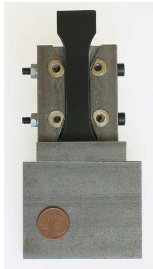
Abb. 4.20: Schlanker Druckprobekörper mit Führung (geöffnet) [8]
