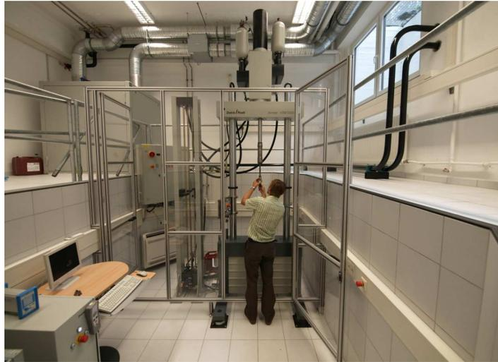
Abb. 3.6: Servohydraulische Hochgeschwindigkeitsprüfmaschine HTM5020
