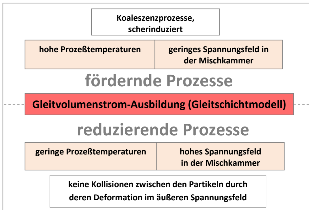
Abb. 110 : Wandgleiteffekte durch niederviskose Rezepturbestandteile (z.B. Octadecylamin)
