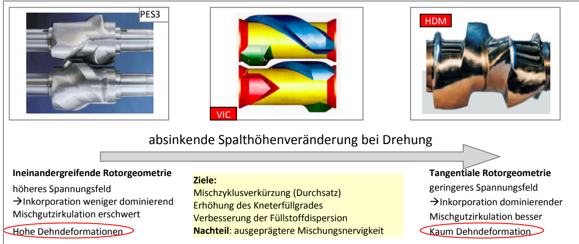
Abb. 102: Einfluß der Rotorgeometrie auf die Spalthöhenänderung, Intermesh- und Tangential-Verfahren
