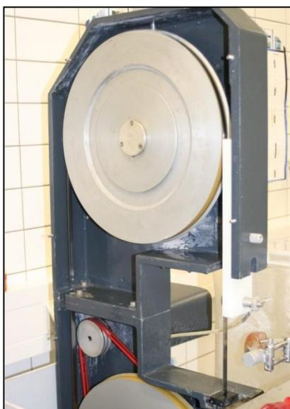
**Abb. 16:** *Exakt*<sup>®</sup>-Trennschleifsystem
