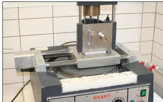
**Abb. 19:** *Exakt*<sup>®</sup>-Mikroschleifsystem
