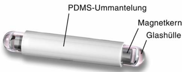
ABBILDUNG 8: SCHEMATISCHE DARSTELLUNG EINES PDMS-BESCHICHTETEN MAGNETRÜHRERS (GERSTEL GMBH & CO. KG 2009)
