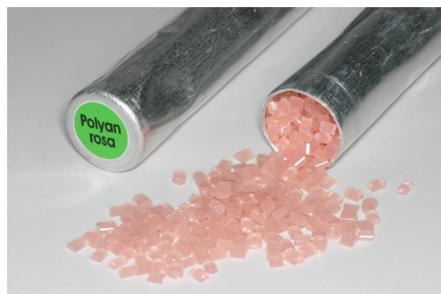
Abb. 7 Getesteter thermoplastischer Kunststoff (Polyan)
