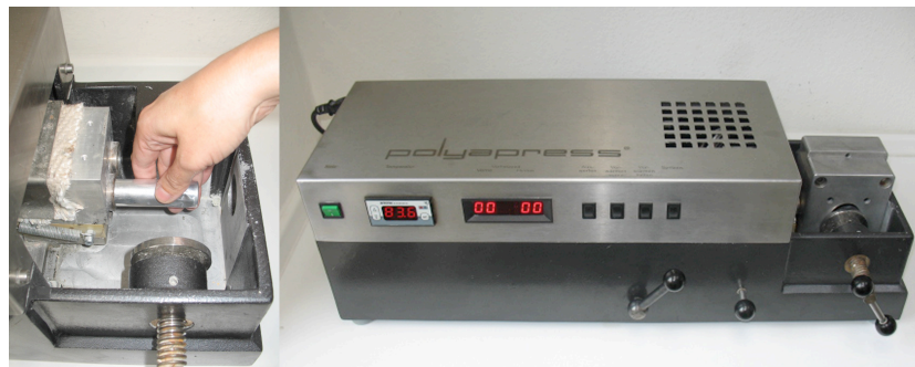
Abb.9 Verwendete Verarbeitungstechnologie (Polyapress-Spritzguss-System)
