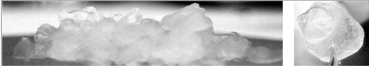
Abbildung 1: Hydrophiles Silica-Aerogel.
