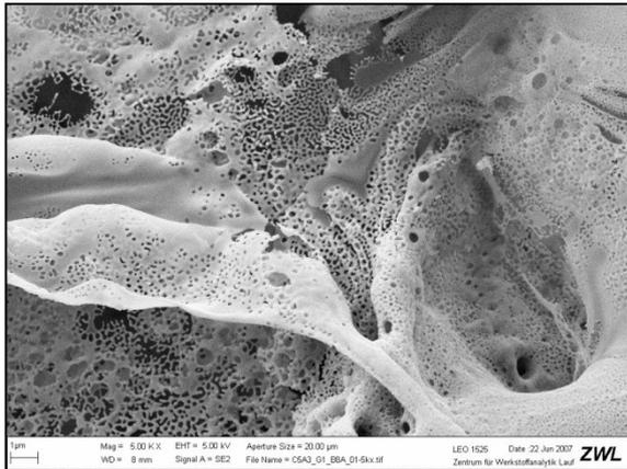
**Abb. 28:** REM-Aufnahme des bei 800°C (2h) gesinterten Precursors aus dem GNP; XRD-Diagramm in Abb. 25b
