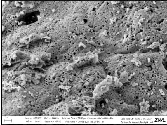
**Abb. 23:** REM-Aufnahme von orthorhombischem CA, hergestellt aus dem bei 900°C (2h) zersetzten Precursor des GNP
