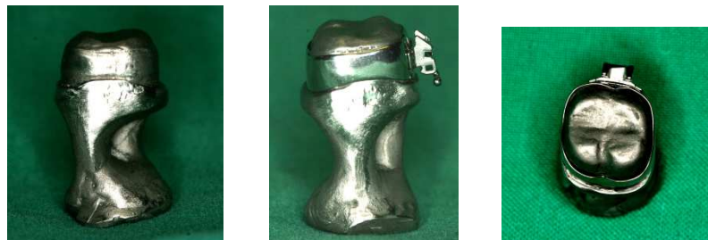
Abb. 23: a) Gegossener Probehalter; b) c) Probehalter mit spannungsfrei aufgesetztem Band
