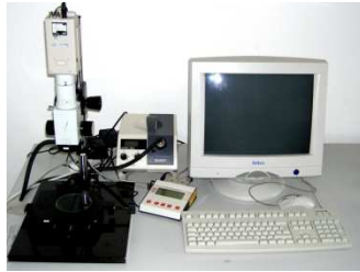
Abb. 12: Video-Mess-Inspektionssystem VMZM/40, Firma Jena Engineering. MLU-Zahnklinik, Abt. Prothetik
