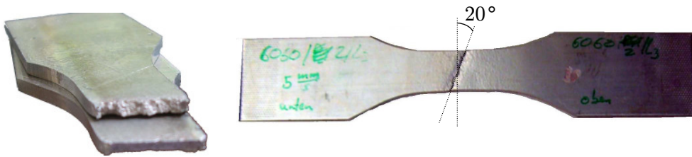
Abbildung 5.25: Rissbild der Aluminium-Zugproben
