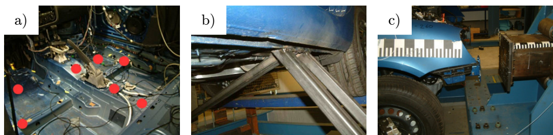
Abbildung 5.14: Versuchsaufbau des Fahrzeugdruckversuchs
