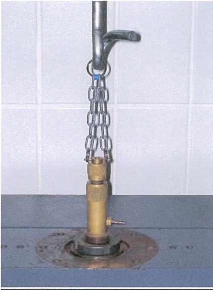
Abb.2 Versuchsapparatur mit Metallhülse und Kette
