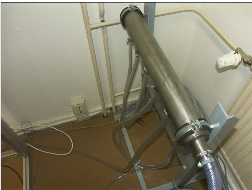
Abb. 4/13: Kunststoffschläuche zur Einleitung stickstoffreicherer Luft in die Höhenkammer
