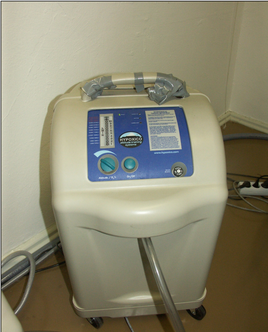
Abb. 4/14: Generatoren (Hypoxico, USA) zum Betreiben der Höhenkammer unter hypoxischen Bedingungen
