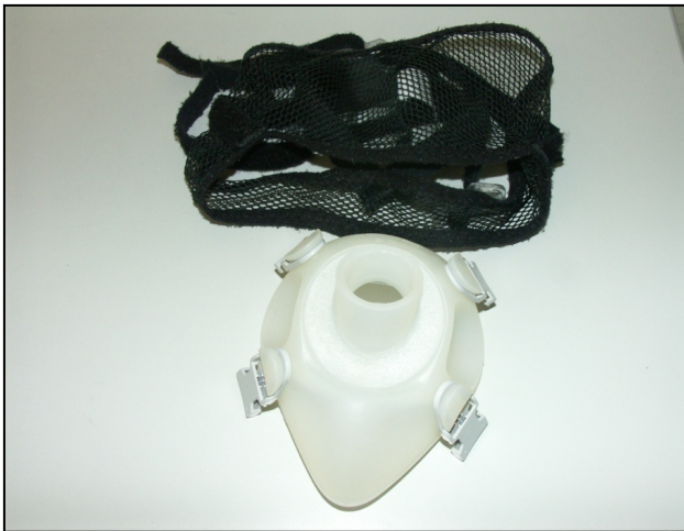
Abb. 4/7: Silikonmaske (mit Netz), die während der Ergometrie ständig getragen wurde
