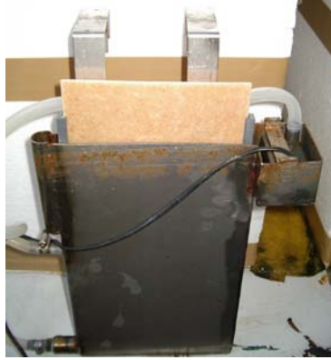
Bild 8. Batch-Reaktor zur Bestimmung der Ex-situ -Atmungsaktivität.
