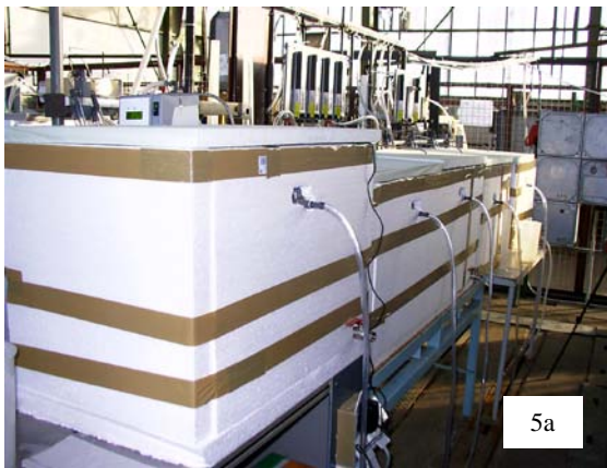
Bilder 5a und 5b. Versuchsanlage aus getauchten Festbett-Reaktoren im Labormaßstab.
