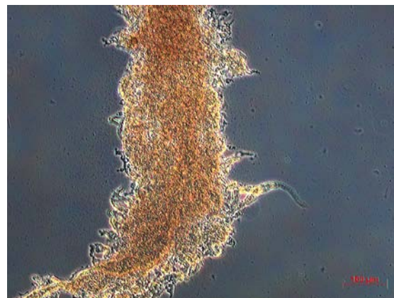
Schlammflocke von Biofilm im getauchten Festbett bei 35 °C ( B_A(\text{NH}_4^+-\text{N})= 1,75 \text{ g/m}^2\cdot\text{d} und B_A(\text{DOC})= 4,4 \text{ g/m}^2\cdot\text{d} ) mit Zugabe von 10 g/l NaCl.
