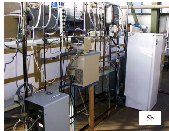
Bilder 5a und 5b. Versuchsanlage aus getauchten Festbett-Reaktoren im Labormaßstab.
