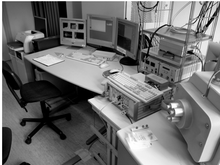
Bild A.3: Messplatz für den in-situ Zugversuch mit simultaner Aufzeichnung der Schallemissionen
