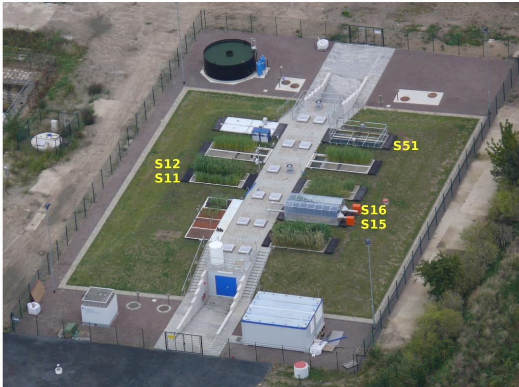
**Abbildung 3.1:** Vogelperspektive der Pilotanlage *Compartment Transfer* in Leuna. S11: Pflanzenmatte, S12/S16: bepflanzt, horizontal durchströmter Bodenfilter, S15: unbepflanzter, horizontal durchströmter Bodenfilter, S51: Strukturiertes Grabensystem, S15/S16: installierte Emissionsmesshauben. Foto: M. Kästner
