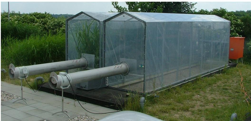
**Abbildung 3.4:** Ansicht des parallelen Aufbaus der DACs auf dem unbepflanzten Bodenfilter (S15, rechts) und dem bepflanzteten Bodenfilter (S16, links).
