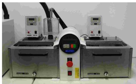
Abb. 17: Thermozyklengerät WEDC1V, Version 2.5, Willytec, München)
