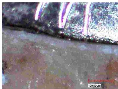
Abb. 31: Zahn: Randspalt nach Zementierung
