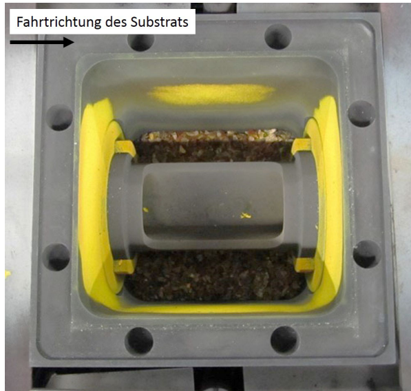
Abbildung 7.2: Cadmiumsulfidtiegel mit installierter Plasmaeinrichtung. Die Rohrblende ist parallel zur Fahrtrichtung des Substrats ausgerichtet und zeigt im Gegensatz zur Tiegelwand aufgrund der starken Erhitzung kein abgeschiedenes CdS auf.
