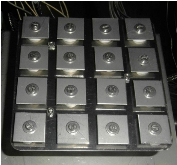
Abbildung 4.1: Der Messkopf der ISSD-Messung mit 16 Sonden, welche einzeln angesteuert werden können.
