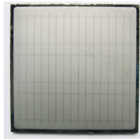
Abbildung 7.8: Rückseite einer strukturierten CdTe-Probe mit 24 einzelnen Solarzellen. Alle Zellen haben eine Fläche von 1 \text{ cm}^2 .
