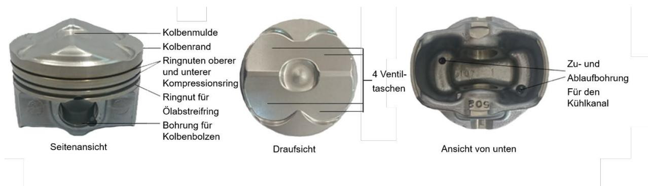
**Abbildung 42: Modifizierter Kolben  $\varepsilon = 13$**
