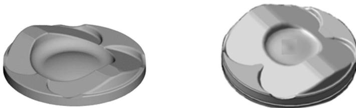
**Abbildung 41: Änderung der Kolbengeometrie; Serienkolben  $\varepsilon = 10$  (links); Modifizierter Kolben  $\varepsilon = 13$  (rechts)**
