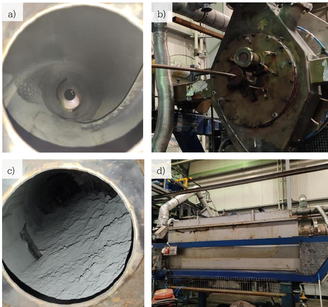
Abbildung 8-2: a) Batchzylinder mit radial zulaufenden Hubschaufeln, b) Ofeneinlaufkopf mit radialer Thermolanze, c) Batchzylinder nach Befüllung, d) Gesamtansicht des Drehrohrofens
