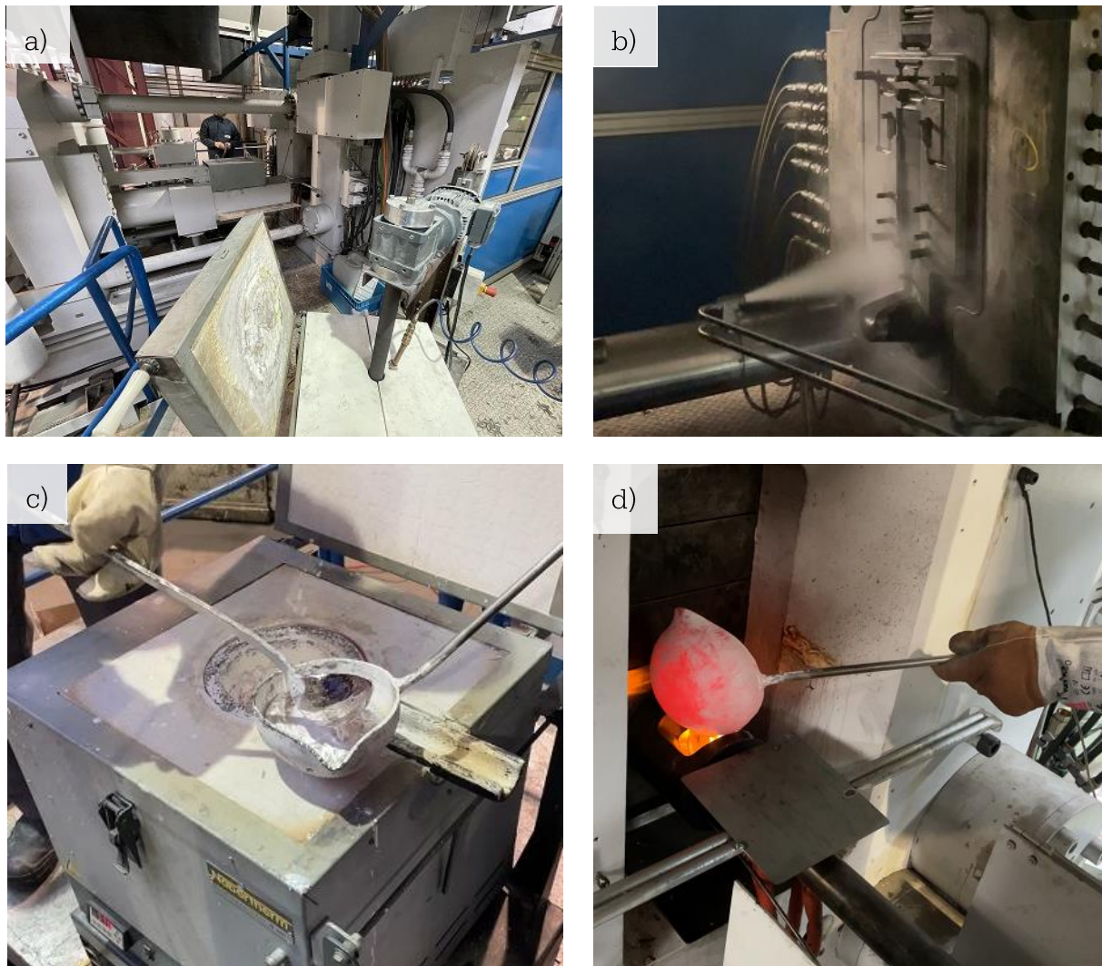
Abbildung 7-5: HPDC-Gießzyklus: a) aufschmelzen der AMCP-Halbzeuge unter Schutzgas und Rührwirkung, b) auftragen von Formtrennmittel durch sprühen per Handdosierung, c) Überführung der Schmelze in die Gießkelle durch umschöpfen, d) manuelle Befüllung der Gießkammer
