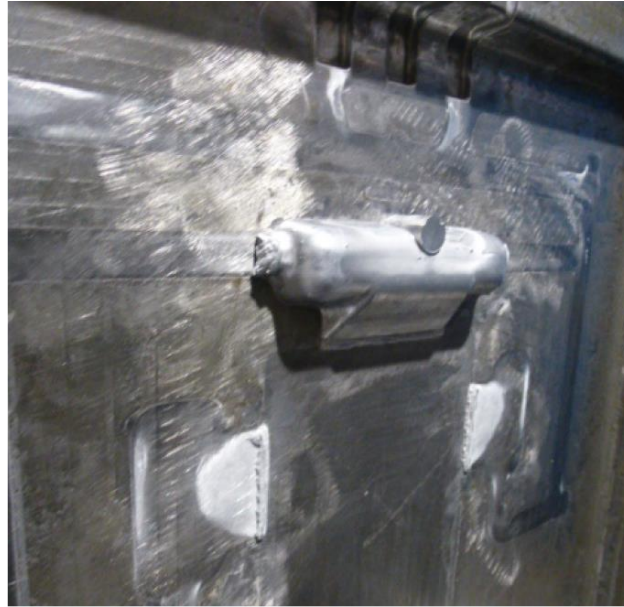
Abbildung 7-11: Beschaffenheit der festen Formhälfte nach dem Abguss eines 30 Vol.-% SiCp AMC
