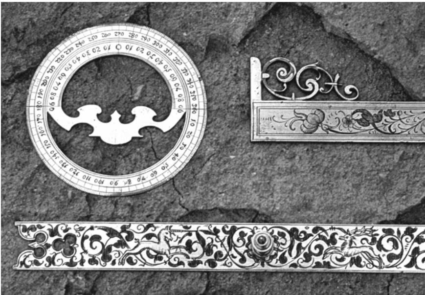
Abb. 11: Winkelmesser, Lineal und Richtschiene, vermutlich zwischen 1580 und 1650 in Deutschland hergestellt [53]
