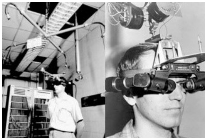
Abbildung 3: Das Ultimate Display von Ivan Sutherland (1965). Diese Erfindung gilt als das erste Head Mounted Displays (HMD) [Iva65].
