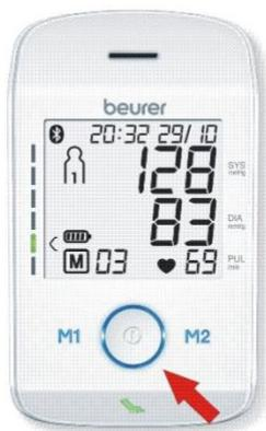
Abbildung 42 Blutdruckmessgerät mit Startknopf-Anweisung
