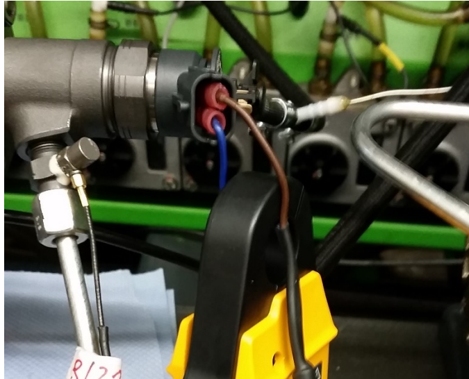
Abbildung 18: Körperschallmessstelle mit appliziertem Beschleunigungssensor (links) und Ansteuersignalabgriff am Injektor mittels Strommesszange (Mitte)
