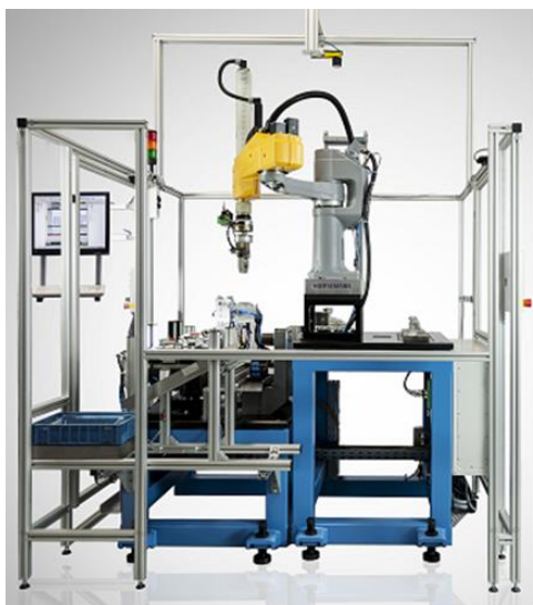
Abbildung 1: Beispiel einer Roboter-gestützten Prüfanlage (Quelle: Fa. Hiersemann Prozessautomation)
