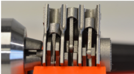
Bild 10: 3-Zylinder Motor, voll beweglich gesintert ohne Stützstrukturen
