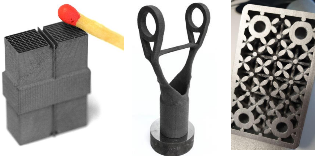
Bild 1: Beispiele additiv-generativ gefertigter Bauteile: Mikrowärmetauscher mit filigransten Innenstrukturen (links), Topologie-optimiertes Bauteil (Mitte) und Bauteil mit Gitterstruktur im Inneren (rechts) [1,2] [Bilder: Laserinstitut Hochschule Mittweida],
