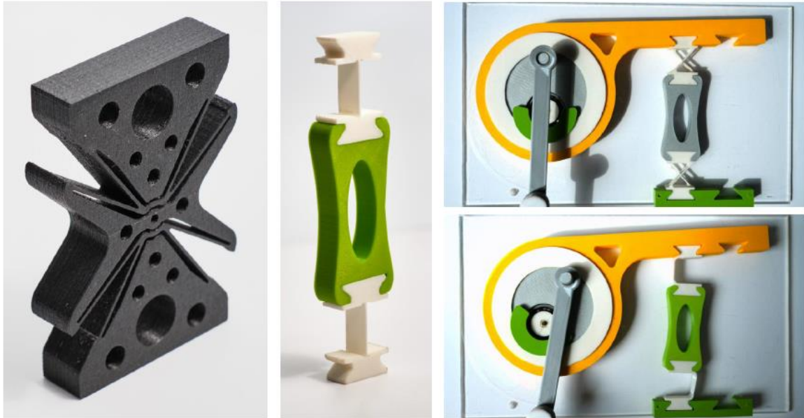
Kurbelschwinge als Führungsgetriebe
