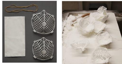
Abb.18: wiederverwendbarer Filterträger; Quelle: Fit Additive Manufacturing Group
