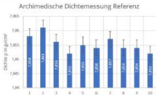
Bild 2: Referenzgraph Edelstahl 316L Dichte Vollmaterial 10 Messungen
