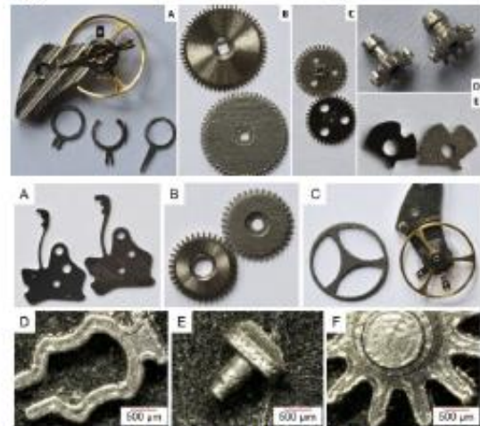
Bild 8: Zahnräder und Teile der Unruh im direkten Vergleich Originalteil und mittels Mikro-SLM hergestelltes Bauteil
