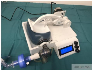
Abb. 6: Notfall-Beatmungssystem mit integrierter Elektronik und Sensorik
