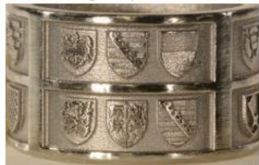
Bild 9: Wappenring – Hergestellt mit dem Mikro-SLM Verfahren, nachtäglich poliert und vergoldet
