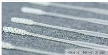
Abb.13: Abstrichstäbchen für Covid-19-Test auf Basis medizinischer Fotopolymere
