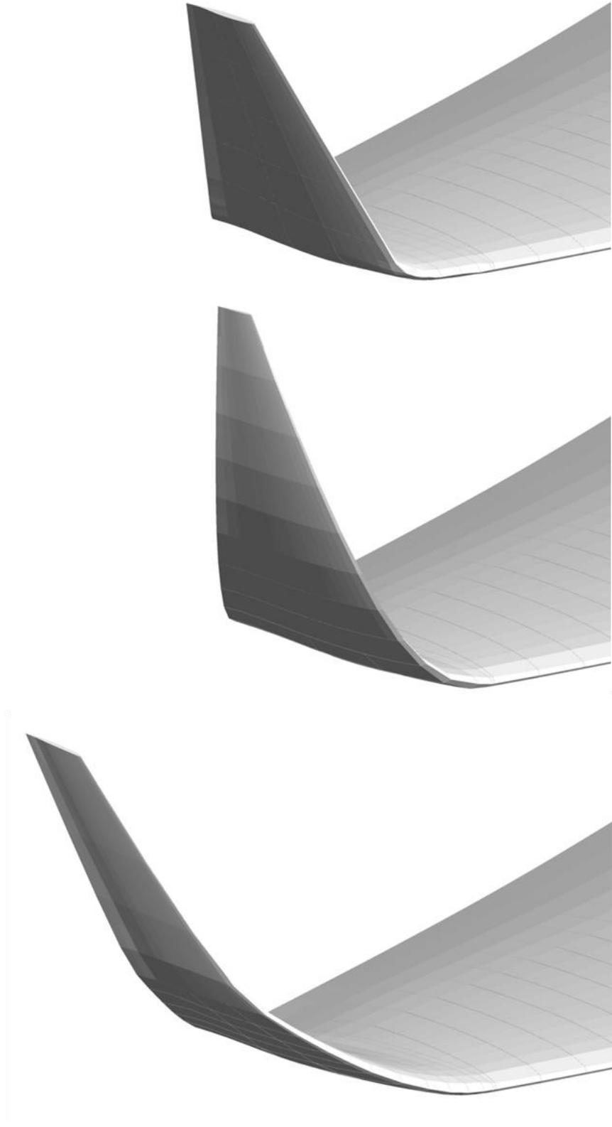
**Abbildung 59: Übertragen eines Strukturkonzeptes auf verschiedene Winglets**
