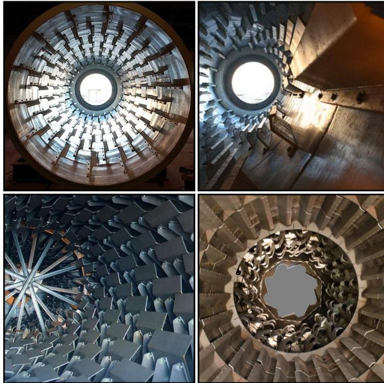
**Abbildung 3:** Innenansichten von Drehrohren mit Hubschaufeln (Bildnachweise: wikipedia.com, fe-co.com, forconstructionpros.com)
