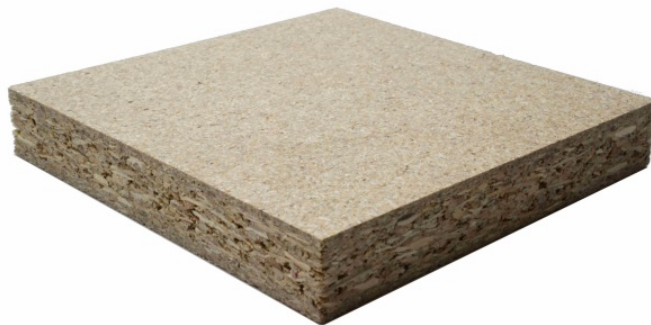
Abbildung 5-2: Spanplatte im Zuschnitt für das Cone Calorimeter
