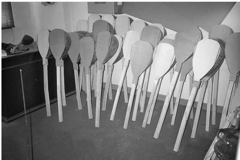
Abb 1: Anatolische Langhalslauten im Prozess der Herstellung (Trockenraum)
