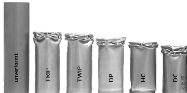
Abb. 1.2: Vergleich verschiedener hochfester Stähle nach schlagartiger Belastung; infolge von Zwillingsbildung im TWIP-Stahl ist die makroskopische Verformung geringer als die konventioneller Stähle (DC - Tiefziehstahl, HC - hochkohlenstoffhaltiger Stahl, DP - Dualphasen Stahl) und in ähnlichem Bereich zum TRIP-Stahl (TRIP - TRansformation Induced Plasticity), welcher die Festigkeitssteigerung durch martensitisches Umklappen erzielt [8]
