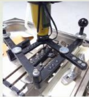
sägen und fräsen horizontal (y) und vertikaler (z) Prüfkörper (ISO 527-2 Typ 1BA)
