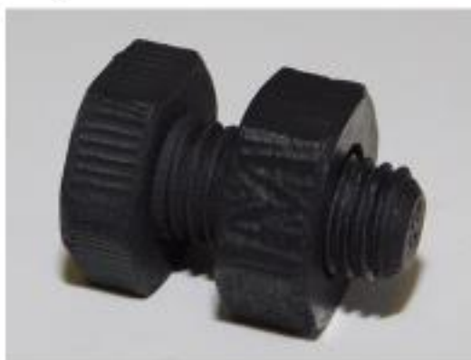
Schraube aus drucklos gesintertertem Siliziumcarbid
