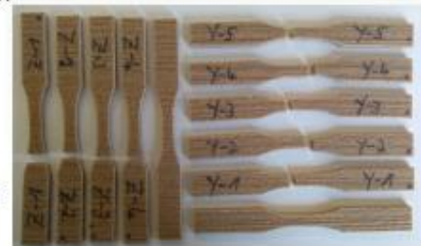
sägen und fräsen horizontal (y) und vertikaler (z) Prüfkörper (ISO 527-2 Typ 1BA)
