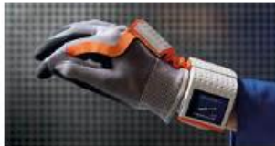
Industriehandschuhe mit integrierten Sensoren (Druck, Temperatur)
