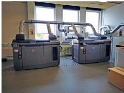
HP Multi Jet Fusion Anlagen der 3Faktur GmbH
