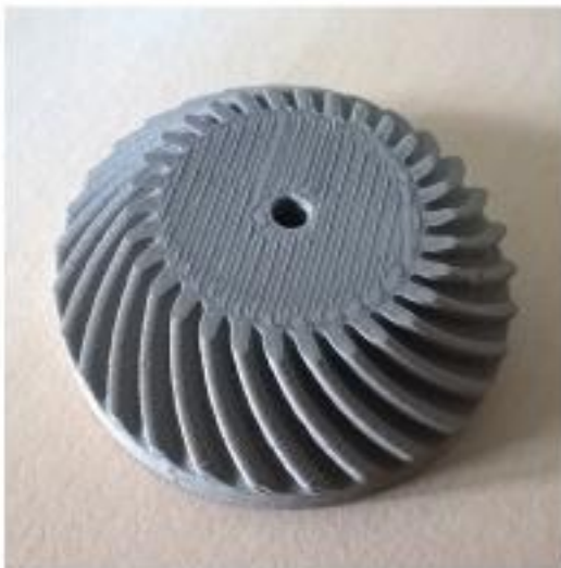
Konisches Zahnrad, aus Granulat gedruckt
