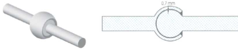
Abbildung 4. Mindestabstand zwischen beweglichen Teilen
