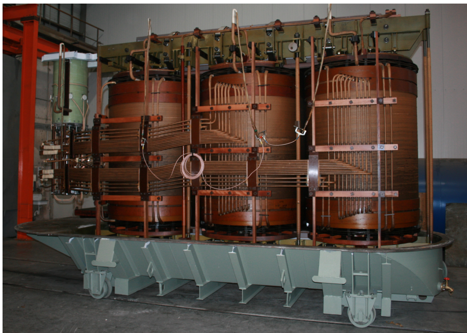
Abbildung 2.19: offenes Aktivteil bei Firma Miebach kurz vor der Trocknung
