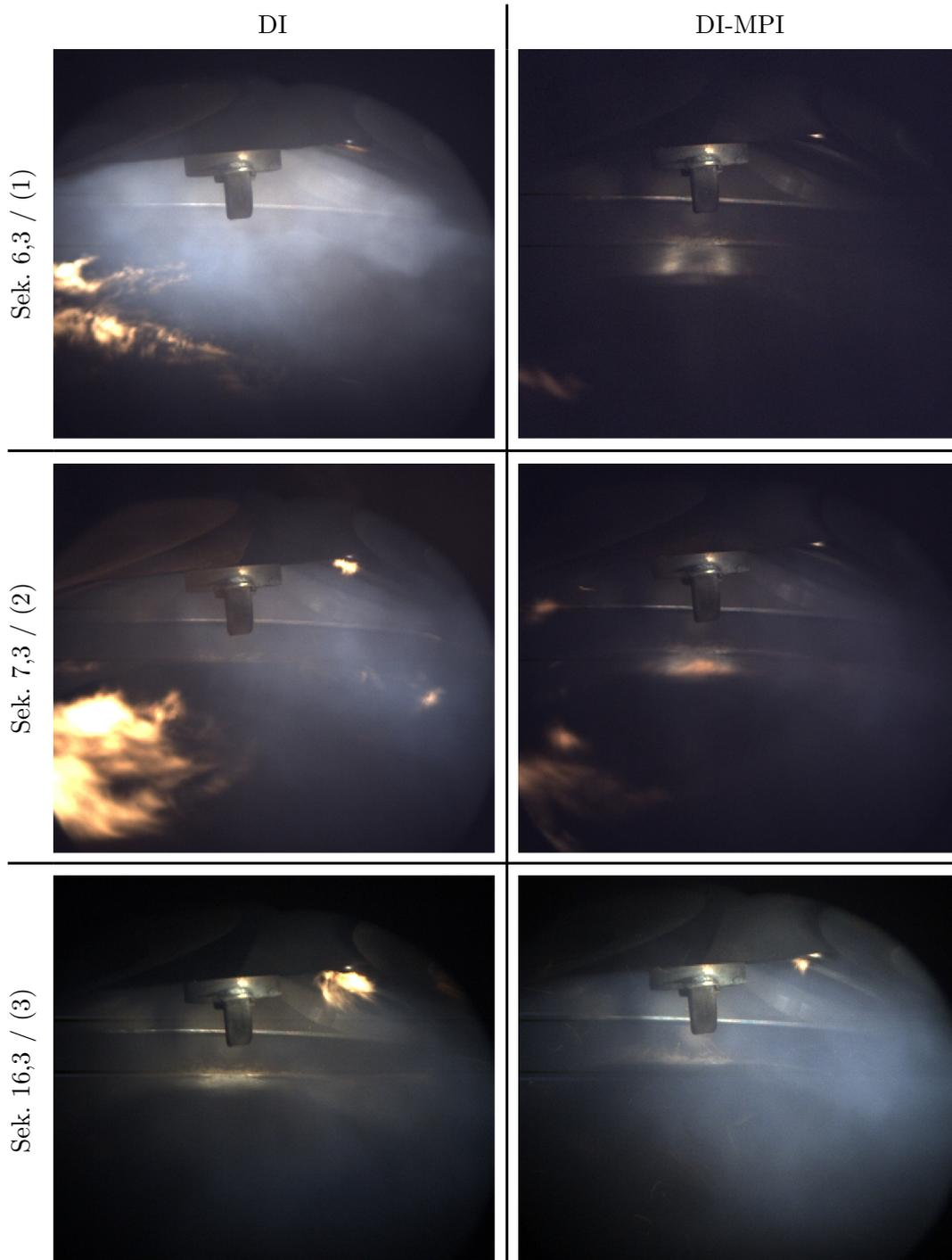
**Abbildung 7.13:** Vergleich der Diffusionsflammen zwischen der Einspritzstrategie DI und DI-MPI während einer Vollast-Beschleunigung.
