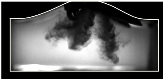
(c) SOI = 280 °KW bei 3000  $\frac{U}{min}$  (Aufnahme bei 272,1 °KW)
