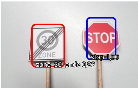
Abb.2: Erkennung von Objekten (hier Verkehrszeichen) mittels TensorFlow
