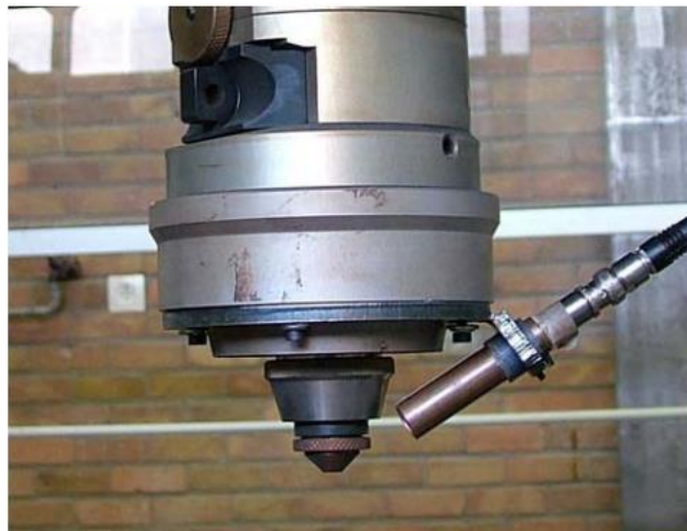
Abbildung 5.10: Installationsort des Mikrofons [21]
