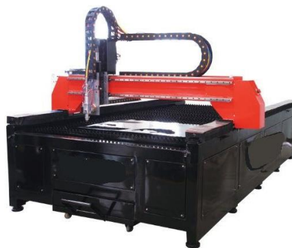
Abbildung 4.4: Lasermaschine mit Portalstruktur [10]
