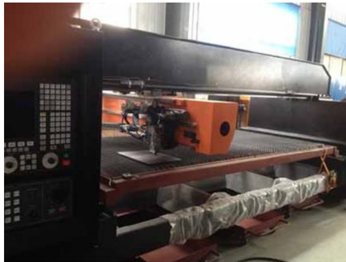
Abbildung 4.6: Lasermaschine mit Querträgerstruktur [12]
