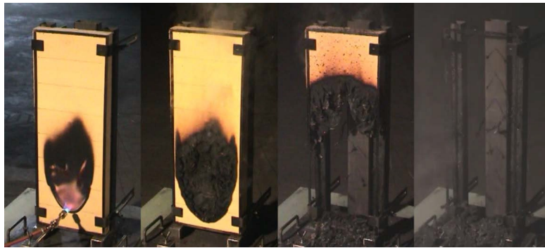
Abbildung 2.4: Schwelprüfung nach DIN EN 16733 mit Holzfaserdämmplatten während der Beflammung, unmittelbar danach sowie zwei und sechs Stunden nach der Beflammung [21]
