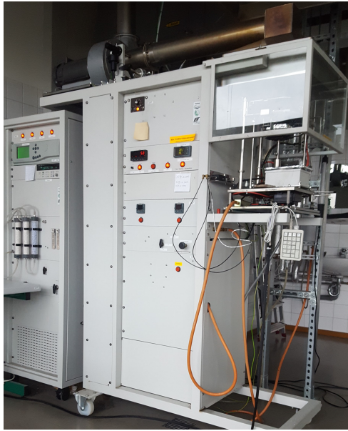
Abbildung 4.3: Cone-Kalorimeter der Hochschule Magdeburg-Stendal
