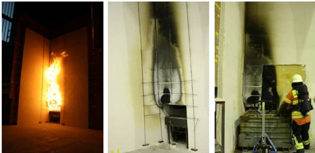
Abbildung 2.5: Holzfaser-WDVS im Fassadenprüfstand während der Beflammung (links), während des Versuches (mitte) und nach der Öffnung nach 74 Stunden (rechts) [Foto: Judith Küppers, iBmB Braunschweig]
