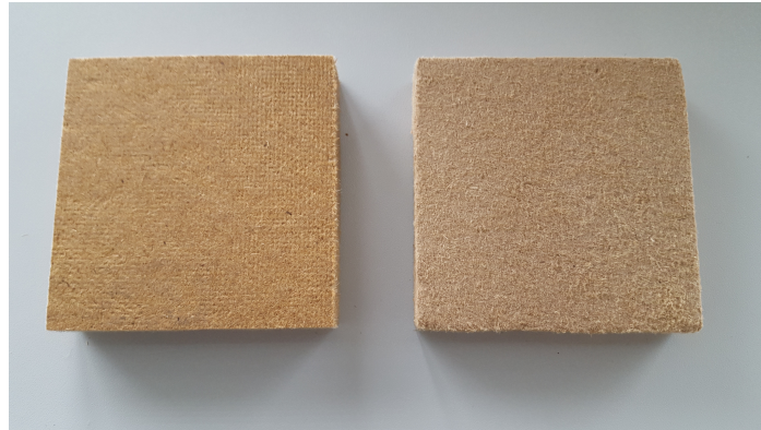
Abbildung 4.1: Zugeschnittene Holzfaserdämmplatte mit verpresster Oberfläche (links) und nach Bearbeitung (rechts)
