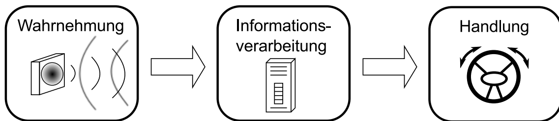
Abbildung 2.1: Schematischer Aufbau eines Assistenzsystems
