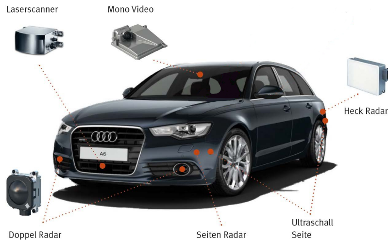
Abbildung 5.8: Versuchsfahrzeug Audi A6 Avant mit Verbauorten der Sensorik (Kreßler 2015)
