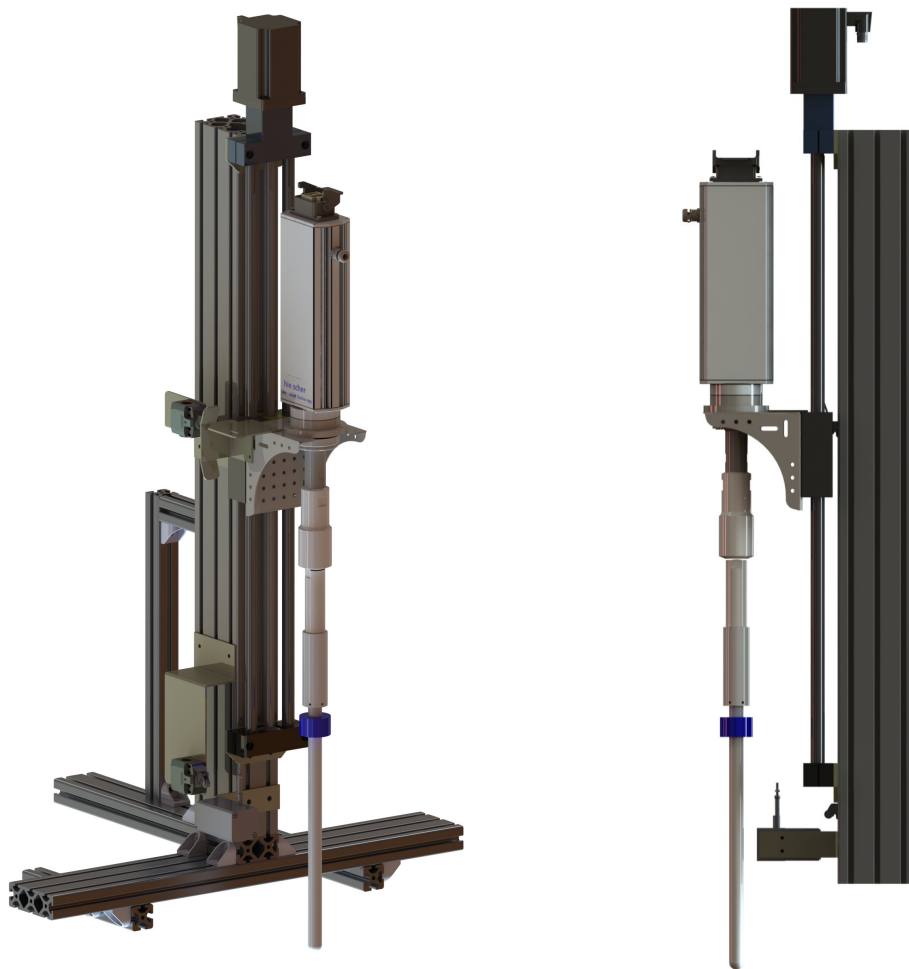
Abbildung 7.1: CAD-Konstruktion der Vorschubvorrichtung zur Positionierung der Sonotrode, einschließlich Schallwandler, Booster, Sonotrode und Resonator. Beschriftung entsprechend Abbildung 7.2 .
